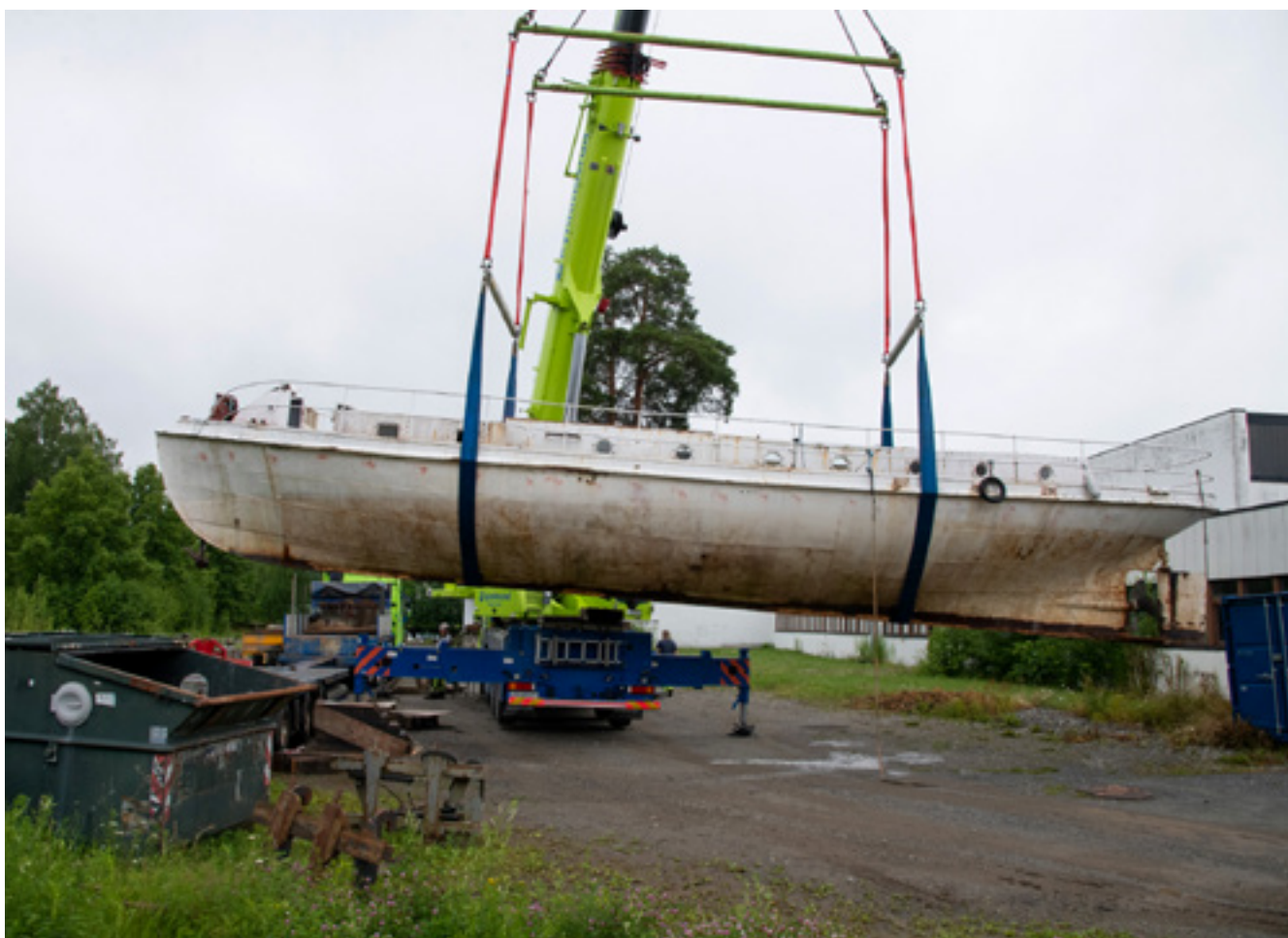
D/S Tyrvi ble i februar 2023 fraktet fra Hensmoen til Helgelandsmoen for sandblåsing og maling. Her losses den av på Helgelandsmoen.
